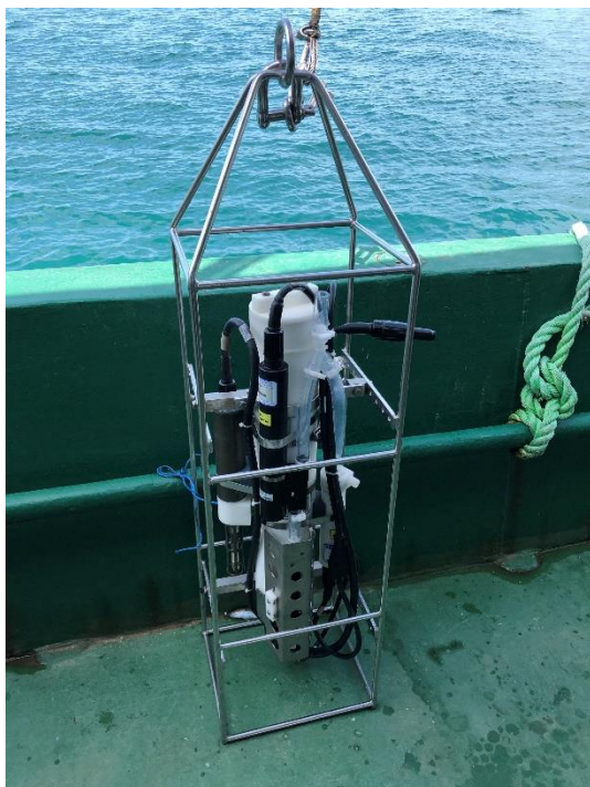
Рисунок 3.4 - Океанологічне обладнання (CTD) для вимірювання основних параметрів води
