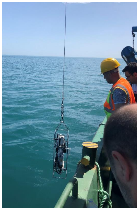
Рисунок 3.4 - Океанологічне обладнання (CTD) для вимірювання основних параметрів води
