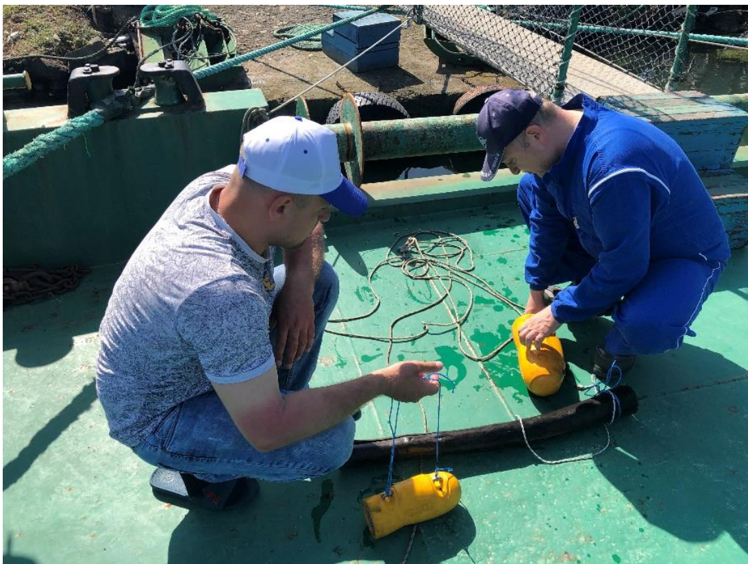
Рисунок 3.3 - Датчики для вимірювання вертикального та горизонтального розкриття трала
