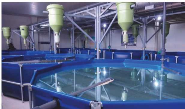
Рис. 5.2. Виробництво в рециркуляційній аквакультурній системі
